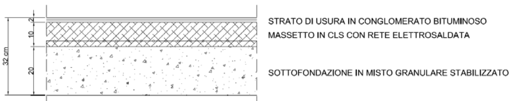
Figura 5: sezione tipo: pavimentazione marciapiedi e piste ciclopedonali
