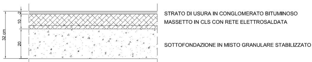
Figura 5: sezione tipo: pavimentazione marciapiedi e piste ciclopedonali
