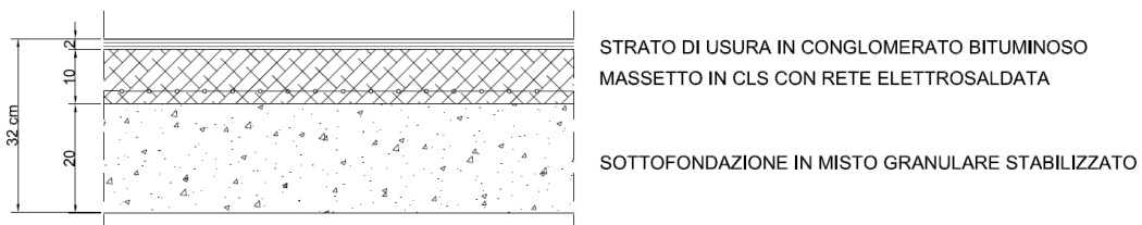
Figura 5: sezione tipo: pavimentazione marciapiedi e piste ciclopedonali
