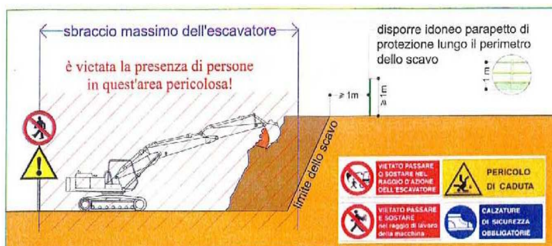
Figura 11: scavo di sbancamento
