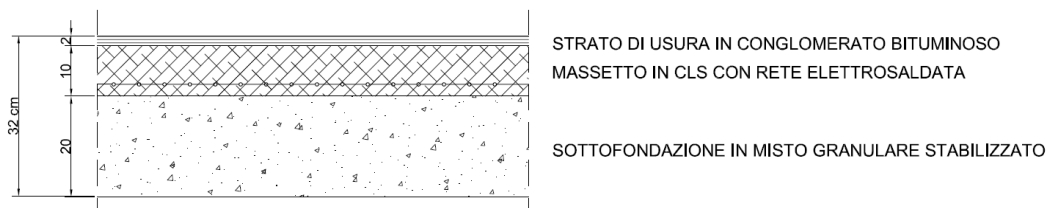
Figura 5: sezione tipo: pavimentazione marciapiedi e piste ciclopedonali
