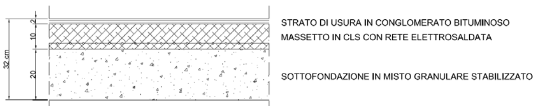
Figura 4: sezione tipo: pavimentazione marciapiedi e piste ciclopedonali
