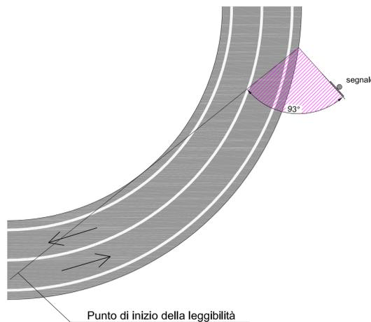
**Installazione laterale in curva destrorsa in assenza di ostacoli che limitano la visibilità**
