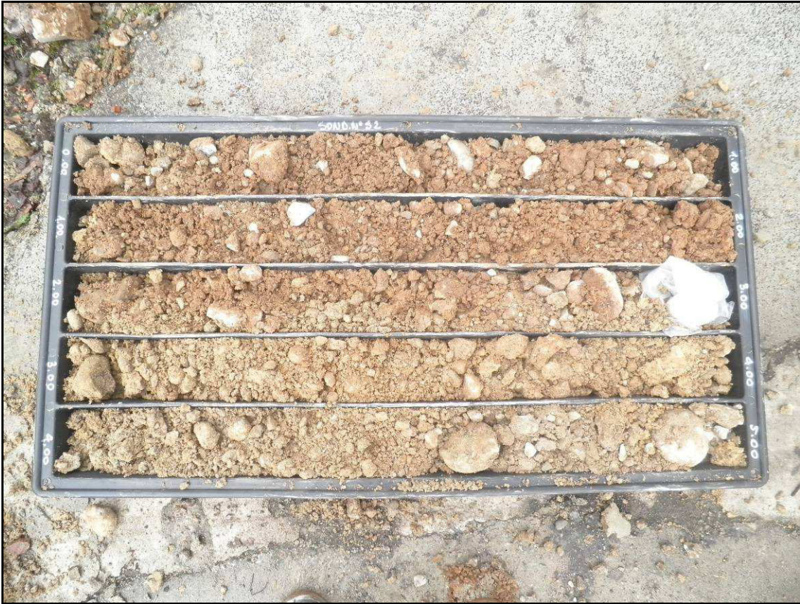
Sondaggio S2 da m 0,0 a 5,0 m.
