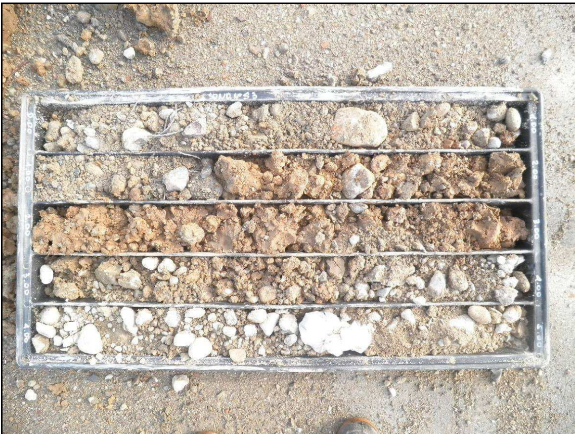
Sondaggio S3 da m 0,0 a 5,0 m.
