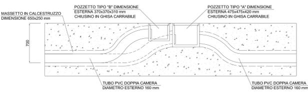
SEZIONE CAVIDOTTO A 3 TUBI INTERRATO IN MASSETTO (SEZIONE A-A) SVILUPPO SU CICLOPEDONALE LATERALE
