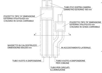
SEZIONE CAVIDOTTO A 1 TUBO INTERRATO IN MASSETTO (SEZIONE A-A) SVILUPPO SU CICLOPEDONALE LATERALE
