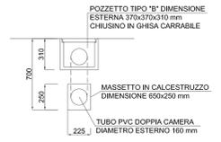
SEZIONE CAVIDOTTO A 2 TUBI INTERRATO IN MASSETTO SVILUPPO SU SPARTITRAFFICO CENTRALE
