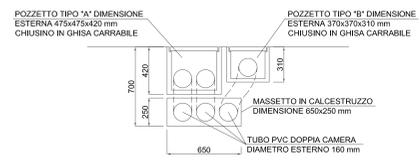
PIANTA CAVIDOTTO A 3 TUBI INTERRATO IN MASSETTO SVILUPPO SU CICLOPEDONALE LATERALE
