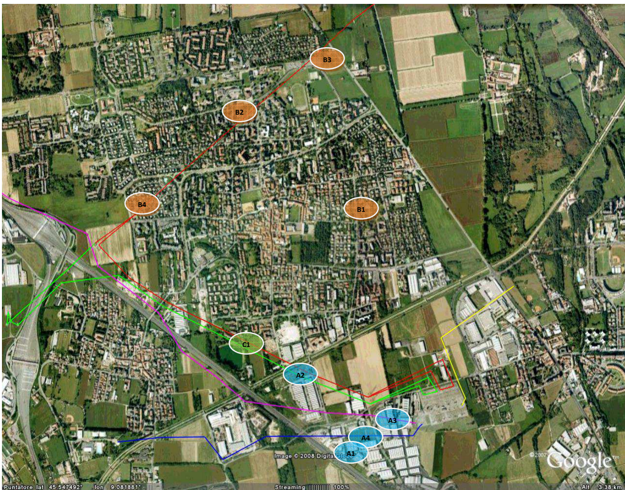
Figura 4.10.1. Dislocazione degli elettrodotti e dei punti di misura sul territorio, ns. elaborazione su M. Senigallesi, luglio 2008.
