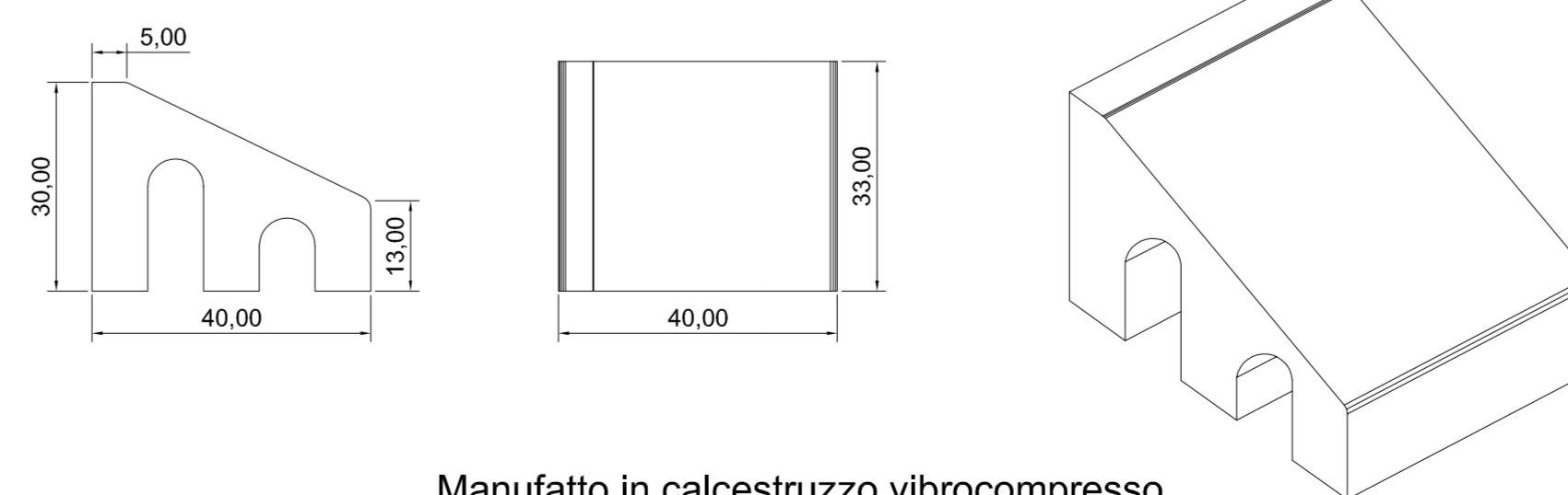
PARTICOLARE CORDOLO "ISOLA DI TRAFFICO" Scala 1:10
