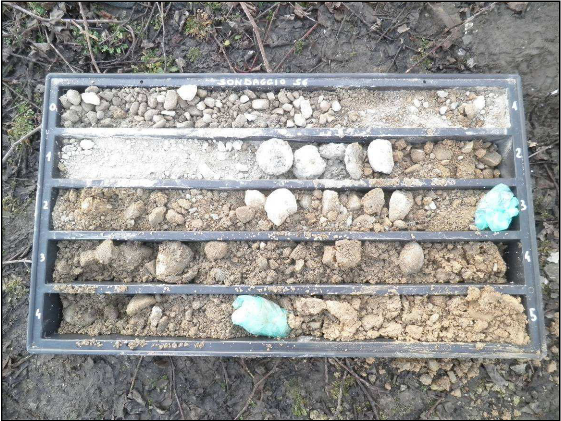
Sondaggio S6 da m 0,0 a 5,0 m.
