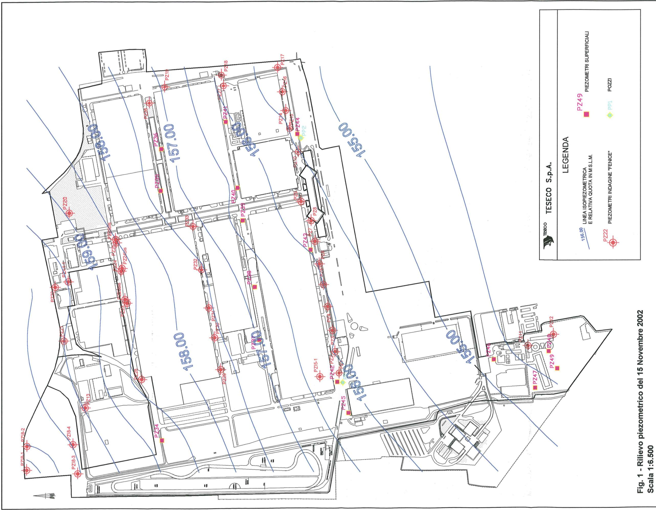
Fig. 1 - Rilievo piezometrico del 15 Novembre 2002
