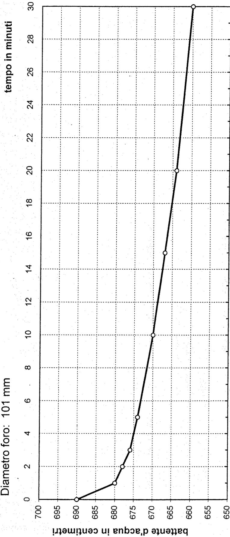
COEFFICIENTE DI PERMEABILITA':  $K = 2.82 \times 10^{-5} \text{ cm/sec}$
