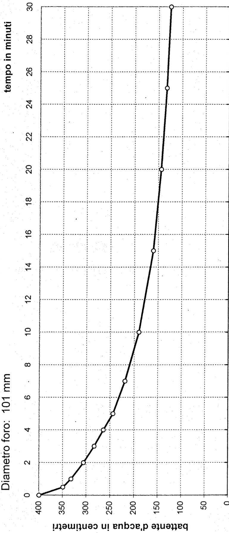
COEFFICIENTE DI PERMEABILITA':  $K = 6.47 \times 10^{-3} \text{ cm/sec}$
